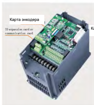
Схема установки для моделей 4,0–9,0 кВт разъемы карт расширения
