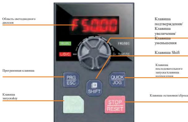
Рисунок 4-1 Схема панели управления 1 (стандартная конфигурация светодиодной клавиатуры 1)
