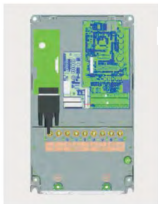
Схема установки карты расширения модели серии DST-K мощностью 11 кВт и выше
